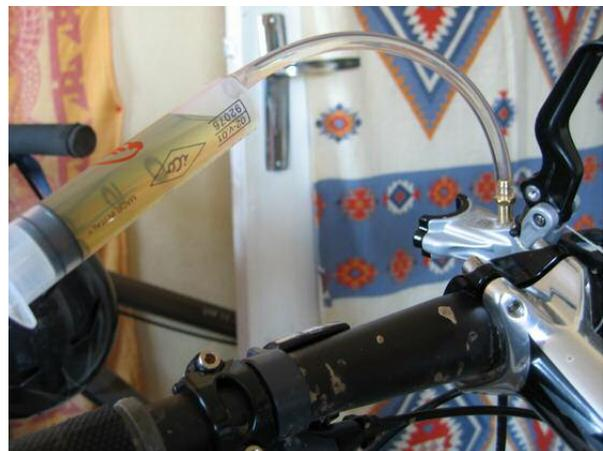
Poursuivre ainsi la purge jusqu'à avoir presque complètement vidé la seringue fixée sur l'étrier. Celle-ci doit conserver un peu de liquide de frein, au moins dans le flexible, afin d'éviter l'introduction de bulle d'air dans le circuit.
