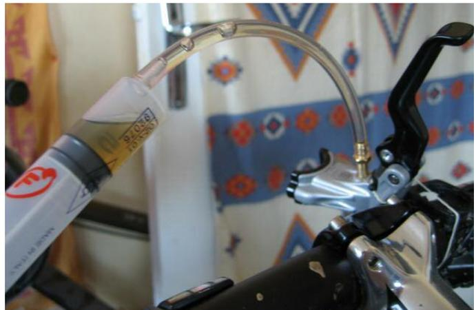
En même temps que le niveau dans la seringue fixée sur l'étrier baisse, le niveau dans la seringue fixée sur le levier augmente, repoussant ainsi le piston de celle-ci.
